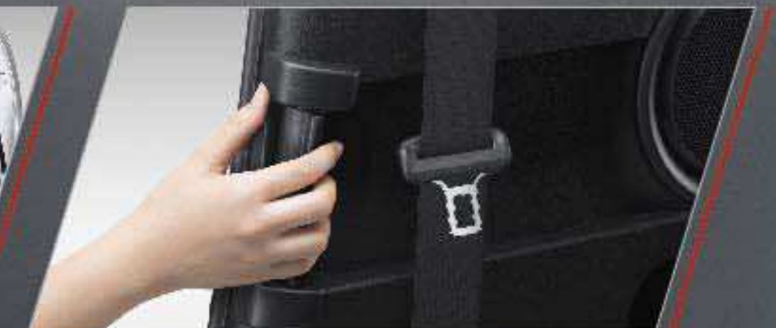
มือจับสมาร์ต แกด ตำแหน่งที่จับ ถูกวางให้เปิด-ปิด สะดวกทั้งจากภายใน และภายนอก
