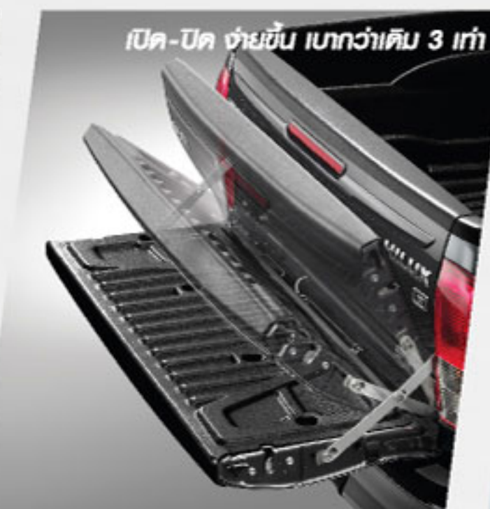
เปิด-ปิด ช่วยขึ้น เบากว่าเดิม 3 เท่า อุปกรณ์ช่วยผ่อนแรงเปิด-ปิดท้ายกระบะ Tailgate Lift Assist
