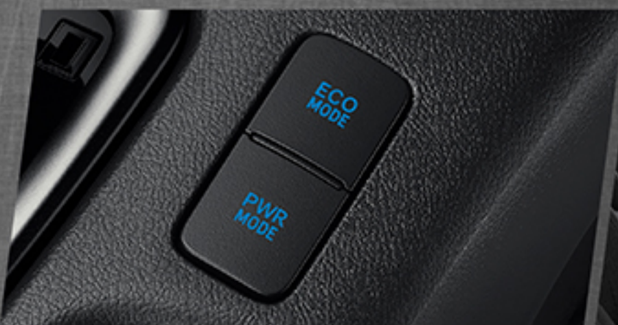
สวิตช์ปรับรูปแบบการขับขี่ เลือกได้ทั้งแบบประหยัด (ECO Mode) และแบบสมรรถนะสูง (Power Mode)
