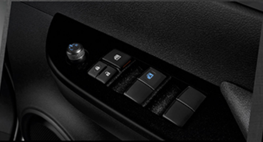
กระจกไฟฟ้า ปรับขึ้น - ลงอัตโนมัติ พร้อมระบบป้องกันการหนีบ (เฉพาะด้านคนขับ)
