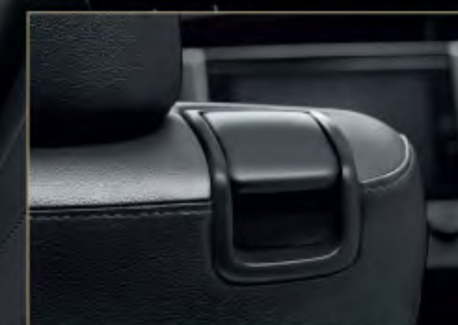
ระบบปรับเลื่อนที่นั่งด้านหน้า Easy Slide Front ช่วยเพิ่มพื้นที่ใหญ่โดยสารแถวที่ 2 อย่างง่ายดาย
