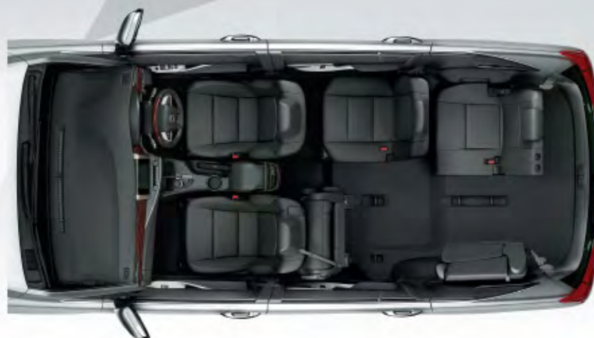
ปรับเบาะแบบ Long Space พับเบาะนั่งแถวที่ 2 และแถวที่ 3 ด้านซ้าย ขยายพื้นที่แนวยาว เพื่อรองรับสัมภาระรูปทรงยาวพิเศษ
