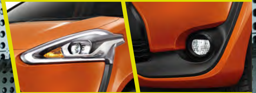
ไฟหน้าโปรเจกเตอร์ Bi-Beam LED พร้อมไฟหรี่ LED
