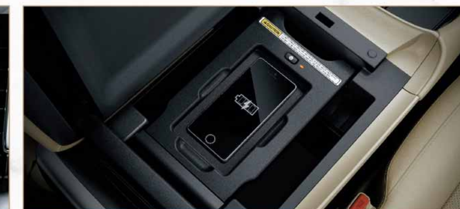
ระบบชาร์จไฟแบบไร้สาย (Wireless Charger) ชาร์จไฟได้ง่าย เพียงวางสมาร์ทโฟนบนแท่นชาร์จ และรองรับการชาร์จไฟตามมาตรฐาน Qi *เฉพาะอุปกรณ์ที่รองรับ และขนาดที่กำหนด
