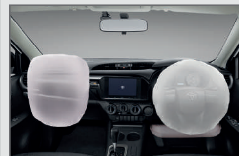
ถุงลมเสริมความปลอดภัย 3 ตำแหน่ง ด้านหน้า 2 ตำแหน่ง / เข่าคนขับ 1 ตำแหน่ง
